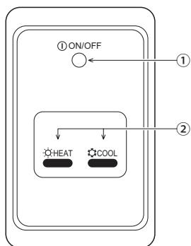
① Светлинен индикатор ВКЛ./ИЗКЛ. (свети, когато устройството работи; не свети, когато устройството не работи)
