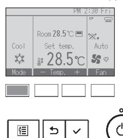
Всяко натискане на бутона [F1] преминава последователно през следните режими на работа. Изберете желания работен режим.
